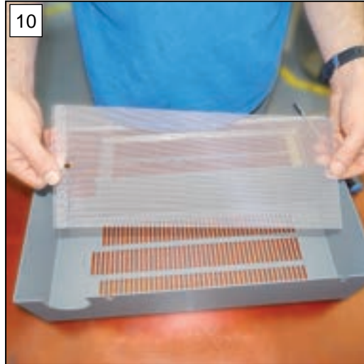
10. Remove the fan fabric.
